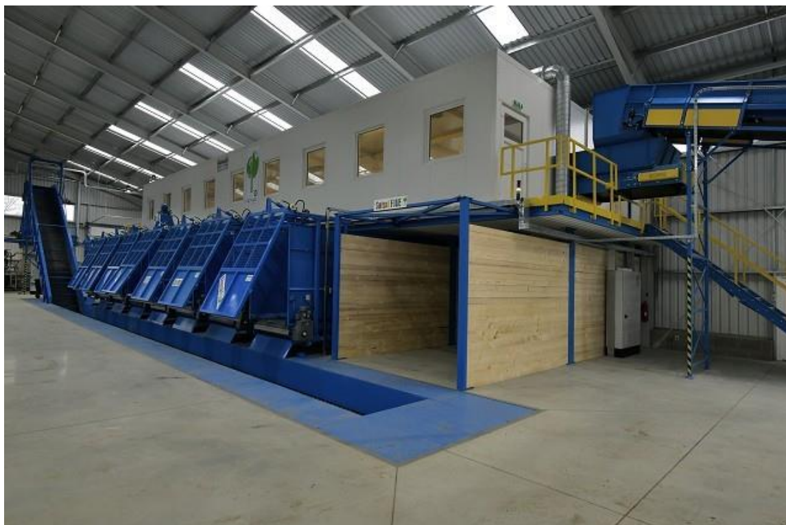
Obrázek 1: Manuální třídící linka společnosti Sompo a.s., s magnetickým separátorem kovů a Eddy currentem.
